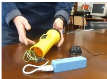
Imagen 9. Linterna con nueva batería
